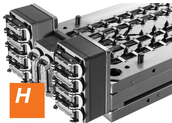
Heißkanalsysteme, Düsen- und Nadelventiltechnik, Regelgeräte.
