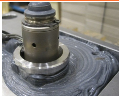
Рисунок 91: Некорректная высота – система залита пластмассой
