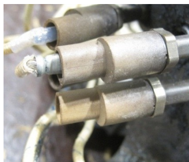
Рисунок 78: Поврежденный кабель нагревателя, слишком маленький радиус сгиба
