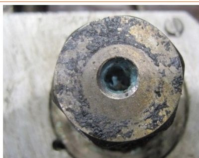
Рисунок 94: Несоосность сопла термопласт-автомата и литниковой втулки
