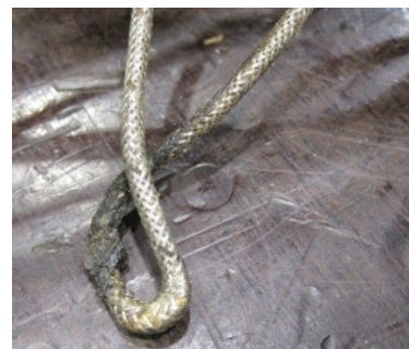
Рисунок 76: Пережатый кабель нагревателя
