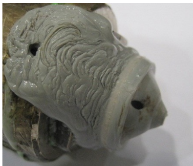
Рисунок 88: Утечка расплава между герметизирующими поверхностями
