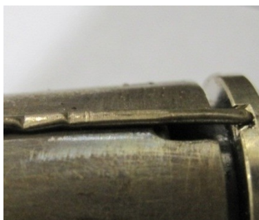
Рисунок 77: Дефектная / раздавленная термопара
