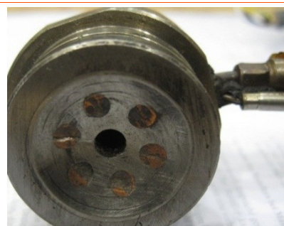
Рисунок 95: Поврежденная сферическая поверхность литниковой втулки – возможна утечка расплава
