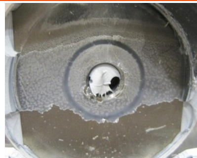
Рисунок 92: Система не подогнана по высоте – недостаточный предварительный натяг
