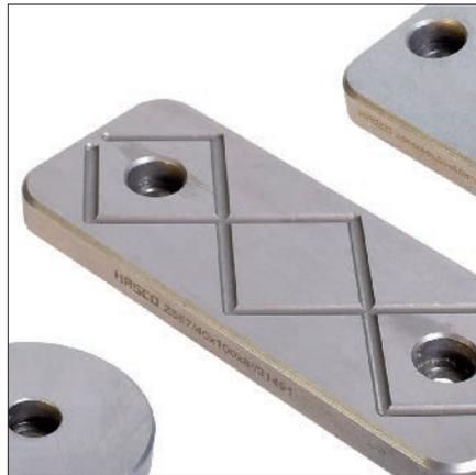
Die innovativen Druck- und Abstimmplatten Z555/..., Z556/... und Z557/... ermöglichen eine gleichmäßige Abstimmung der Formtrennung und einen einfachen Ausgleich von Höhensprüngen. Sie gewährleisten eine definierte Druckverteilung sowie exakte Werkzeugtrennung und verhindern so eine Durchbiegung der Formplatten.
